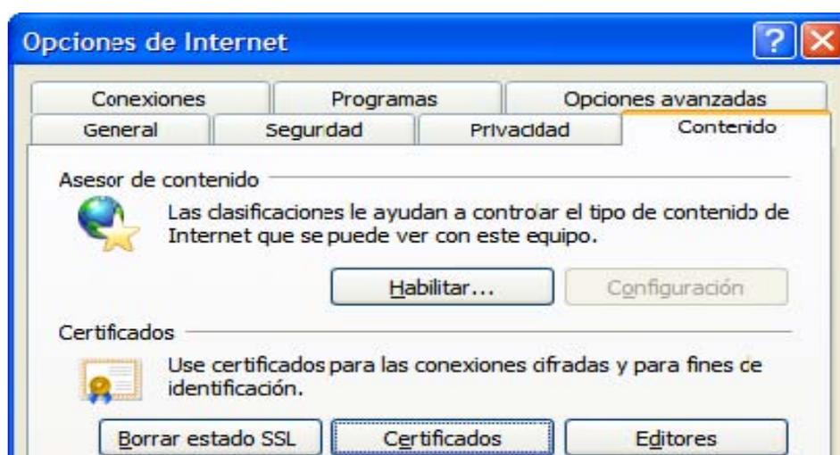
Si está instalado correctamente el módulo CSP del DNIE (Proveedor de Servicios de Certificación) y tiene correctamente instalados los drivers del lector de tarjetas criptográficas e introducido éste en el citado lector, le pedirá el PIN del DNIE.
